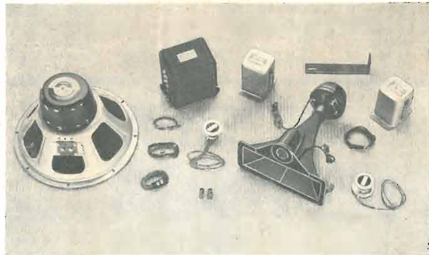
Fig. 2 Complesso d'alto parlanti, CROSSOVER e trasformatori d'uscita per un sistema Hi-Fi di classe (Cortesia Jensen Mfg. Company).
